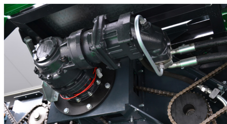
Hydraulisch aandrijfsysteem voor de perskamer
