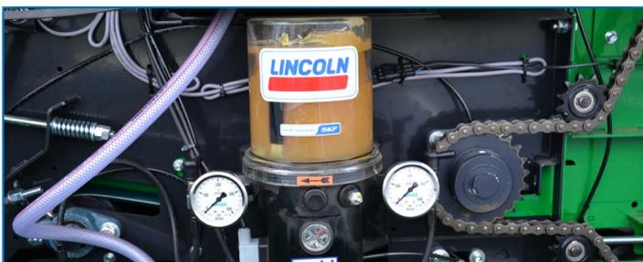
Lincoln automatische Schmierung. Einfach und effizient werden alle Lager und drehende Teile geschmiert. Vollautomatisch, 4 ltr. Tank.
