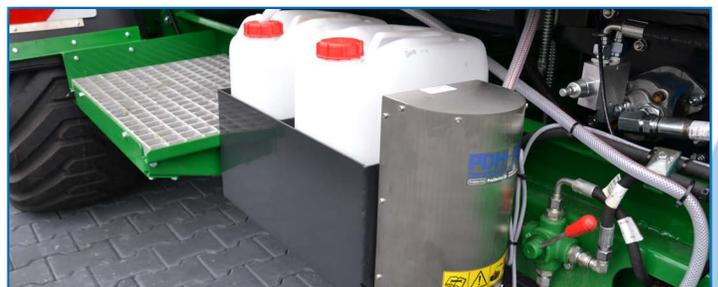
Voll automatische Additiv Dosierung während des Pressens. Pumpleistung 10 ltr./min. Gesteuert von dem AGRONIC Computer.
