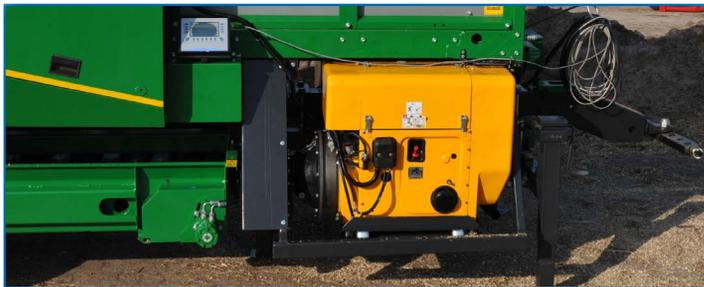
Eine wirtschaftliche Lösung, verbunden mit einem Diesel Motor mit niedrigem Dieserverbrauch. Der geräuschkeduzierte Motor ist an der Maschine installiert was sowohl mobile als auch stationäre Einsätze vereinfacht.
