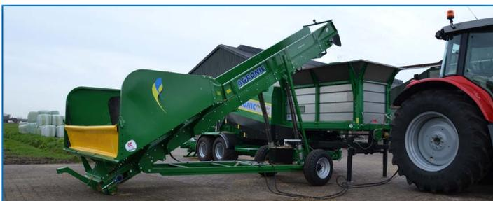
Wenn eine hohe Ladeleistung verlangt wird. Bunker Ladevolumen 2,5-3 ton. Förderbandbreite 1,20 Mtr. Entladen vom Wagen direkt in den Bunker.
