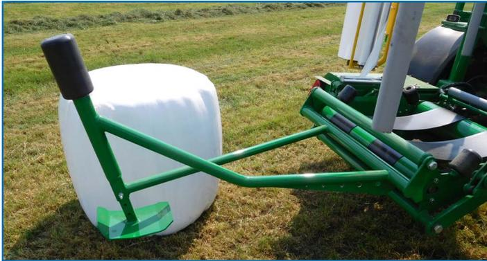
Mit dem Ballenkipanlage entlädt die Maschine automatisch den Ballen an der Seite. Die Seiten des umwickelten Ballens haben mehrere Folienschichten, daher sollte eine Beschädigung verhindert werden durch eine harte Stoppel.
