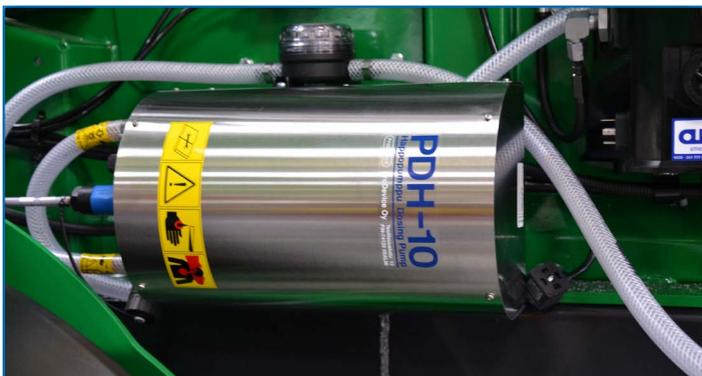
Vollautomatisches Dosiersystem für die Zugabe von Siliermittel während des Pressens. Pumpenleistung 10 ltr./min.
